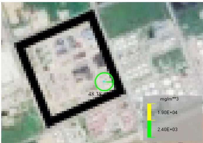
图 1.4-1 大气环境风险预测结果图（甲基叔丁基醚储罐泄漏）
